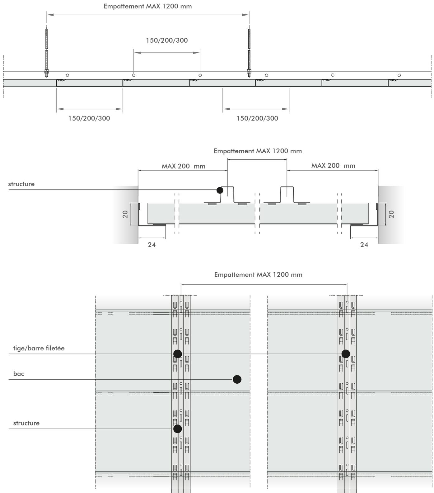
NOTES : les empattements indiqués sont valables pour plafonds montés en intérieur et complets de profil périmétral. Les empattements indiqués sont valables pour le soutien exclusif du poids du plafond. Ces données sont génériques et sont à vérifier en fonction de chaque commande spécifique, en se référant au matériel identifié pour les bacs et les structures, et aux relatives épaisseurs.
