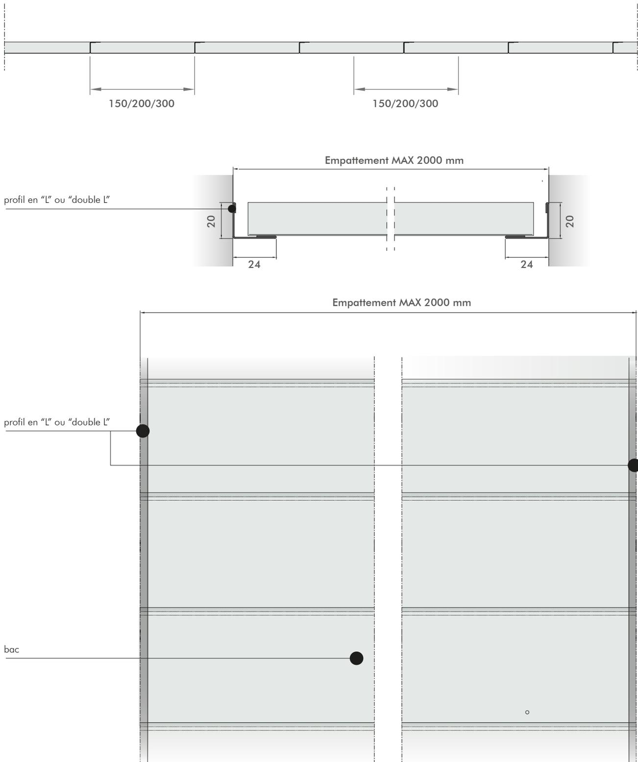
NOTES : les empattements indiqués sont valables pour plafonds montés en intérieur et complets de profil périmétral. Les empattements indiqués sont valables pour le soutien exclusif du poids du plafond. Ces données sont génériques et sont à vérifier en fonction de chaque commande spécifique, en se référant au matériel identifié pour les bacs et les structures, et aux relatives épaisseurs.
